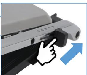
Передвигайте фиксатор крышки вперед или назад
